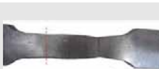
写真-5 2つのネッキング断面(フランジ2)
